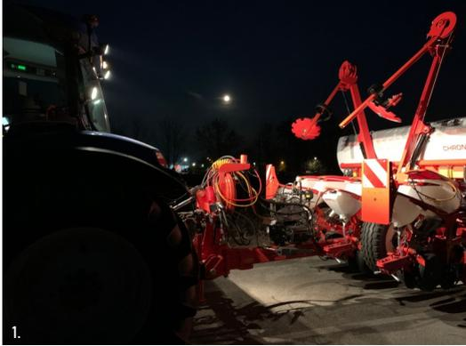
Caratteristiche da considerare: ridotti ingombri per i componenti, masse vicine ai limiti di portata dell'assale, freno idraulico integrato nell'assale, dimensioni elevate dei pneumatici.
